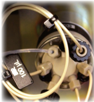
Wymienna pętla nastrzyku próbek, wykonana z PEEK
